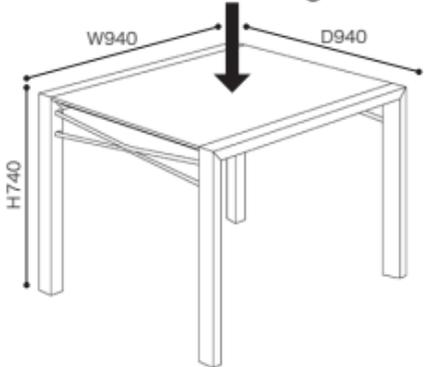
耐荷重 30kg 耐荷重 50kg 耐荷重 30kg
